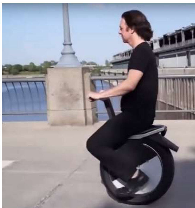
En ethjulet selvbalanceret "motorcykel". Max. hastighed er 35 km/time. Den vejer 29 kg. Prisen er ca. 9.000 kr. Se mere på dette link: https://www.chinavasion.com/china/wholesale/sports-outdoors/Outdoor-Gadgets/One-Wheel-Self-Balancing-Electric-Scooter/?source=ShareASale
